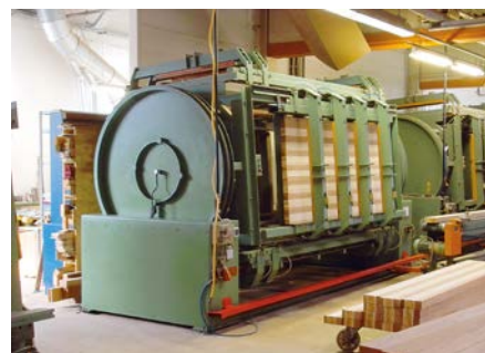
Verleim Rotor bis 6 m. Länge
